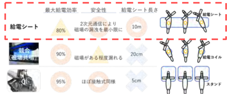
マイクロモビリティ向けの無線給電システムの開発
