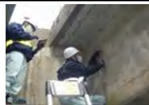
AEセンサーを利用した PCグラウト充填把握
