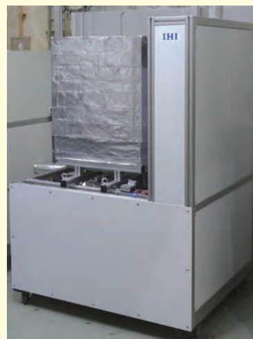
●燃料電池システムの外観
