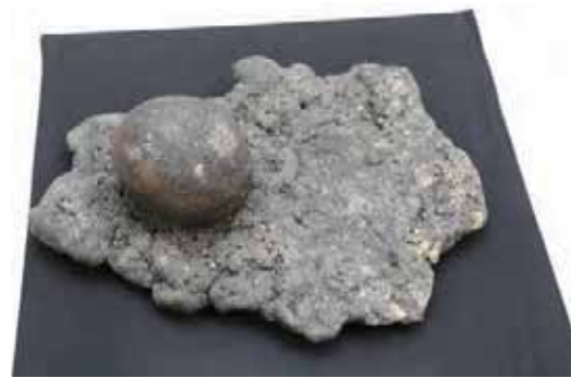
資料01: マンガンノジュール。調査海域ではレアアース泥とともに確認される
