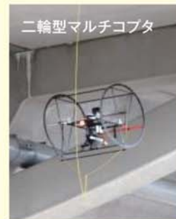
●橋梁点検用ロボット技術
