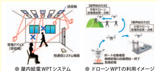
● 屋内給電WPTシステム ● ドローンWPTの利用イメージ
