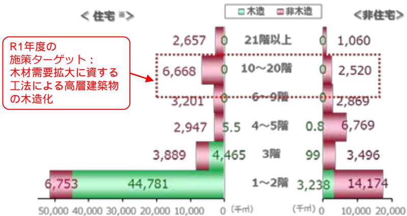
【構造別・階層別 新築建築物の床面積 (住宅※・非住宅, 2019年次)】
