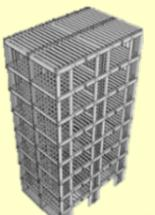
集成材構造 構造計算モデルの例
