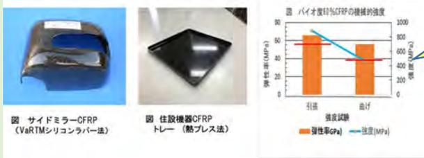
商用化に要する性能 (引張弾性率55GPa, 曲げ弾性率40GPa以上) を担保しつつ、バイオマス度60%以上を達成。
