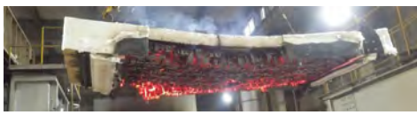
〈耐火試験〉 NLT+CLT合成床試験体 (左) と 中央部のたわみの推移 (上)
