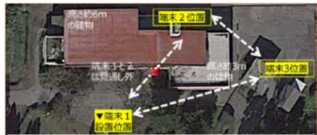
・地上でマルチホップ画像伝送試験を実施し、映像伝送に成功
