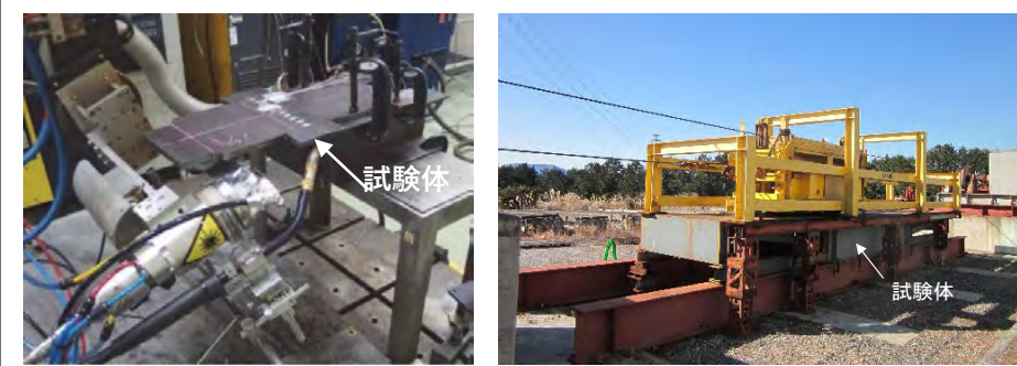
レーザーアークハイブリッド溶接 輪荷重走行試験機による疲労試験 試験施工状況
