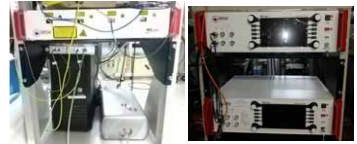
図1 導入した半導体レーザーシステム、精密波長計システム
