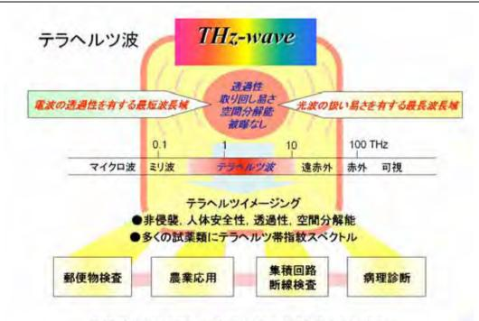
TIセ波は半導体・ブラスチック・紙・ゴム・ビニル・木材・繊維・セラミックス・ コンクリート・粉体・试薬・錠剤・歯・骨・脂肪・乾燥食品・氷などを透過
