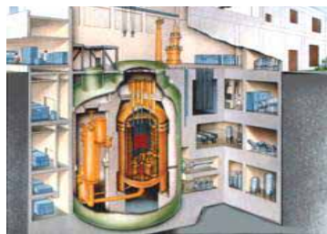
高温工学試験研究炉（HTTR） （我が国唯一の高温ガス炉）
