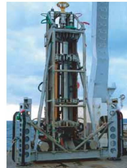
ボーリングマシン(BMS)
