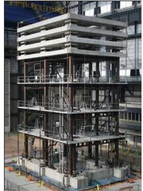
21階建て超高層建物を想定した実規模の試験体による震動台実験
