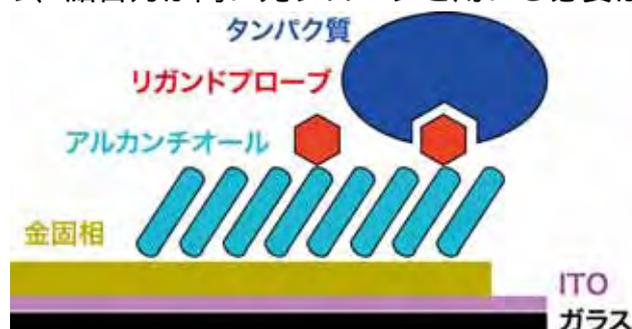
図 1 1. ガラス基板を用いた解析デバイス：ガラス基板上に ITO コーティングし、金薄膜を蒸着。PEG 型アルカンチオールによる SAM と共にプローブを構築し、光クロスリンクで結合タンパク質をトラップする。
