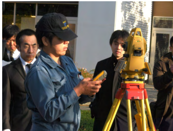
図4 インテリジェント基準点と開発した測量機器を用いた測量作業
