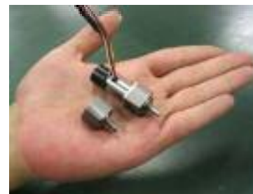
中小企業基盤整備機構 理事長賞 超小型高精度高出力トルク ACサーボアクチュエータ
