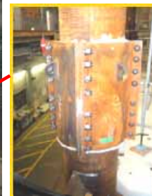
柱・はり・リングソケットの状況 (無損傷)
