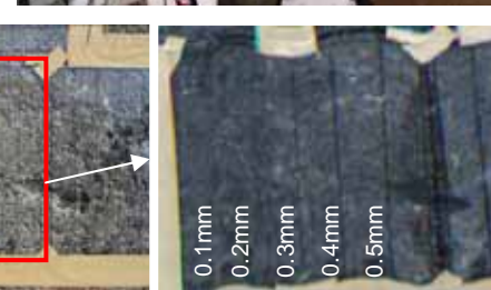
開発したスキャン技術の精度確認試験 (左:デジタルカメラ画像、右:スキャン技術による画像)
