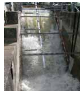
越流実験による耐久性確認
