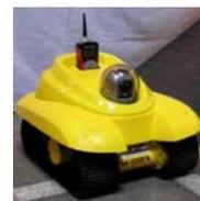
パンチルトカメラ、ガス検知器を搭載したタイプ
