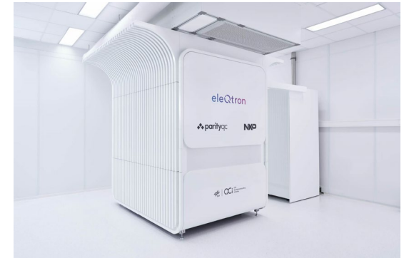
(第1弾PJ) 10量子ビットのイオントラップ型デモ機
