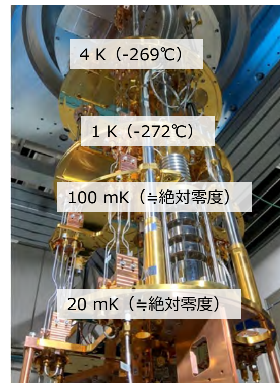
例) 超電導量子コンピュータシステム
