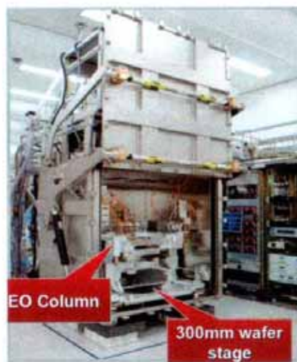
(c) TSMCが研究開発用に導入したEB露光装置
