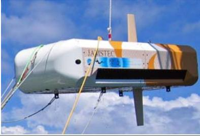
海底を音波を使って探査するこのソナーは、信号処理に <b>合成開口技術</b> を適用し、かつ <b>独自のビームフォーカス処理</b> で動揺を補償することで、従来より <b>精細かつ高コントラスト</b> の海底音響画像を取得する事ができる。                                                                                                                                                                                                                                                                                                                                                                     |
