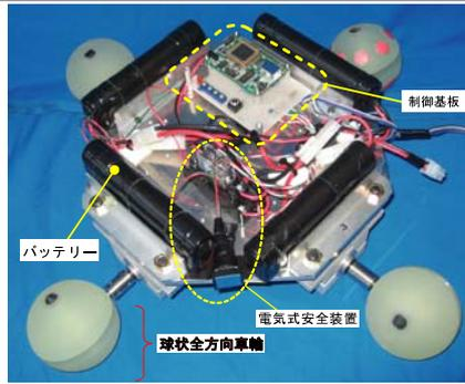
図3：球状全方向車輪を搭載した車両
