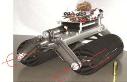
図3：円形断面クローラ機構
