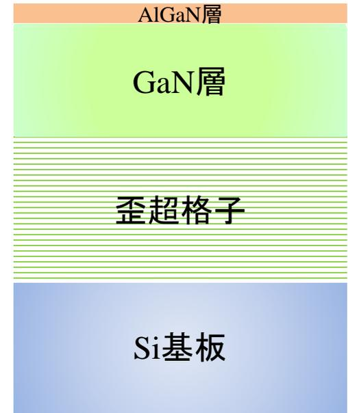
HEMTエピ<sup>o</sup>基板の断面図
