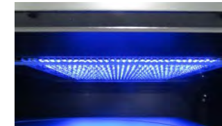
DUV-LEDアレイモジュール (50x50mm 2 )
