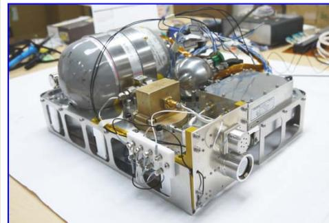
6kg,20Wで比推力1170秒を達成した「世界最高レベル」の超小型イオン推進システム
