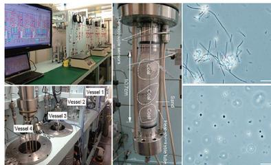
海底石炭を用いた実環境リアクター試験(左:高圧リアクター試験機、中:熱収縮カラムに充填された石炭と砂岩、右:石炭から培養された微生物、スケール:10mm)。
