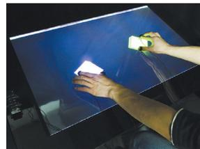
ディスプレイ上で複数指に触力覚を提示するマルチタッチ触力覚提示システム
