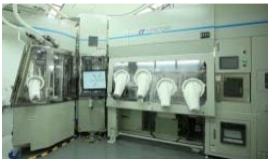
図 2. 細胞シート自動生産装置 (臨床用実機写真)
