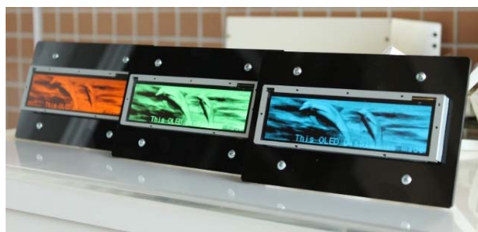
図 3. 有機 EL 発光材料を用いて試作したディスプレイ
