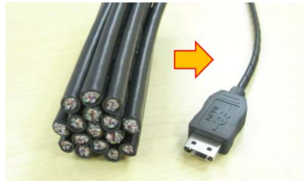
図 1. 8K 非圧縮伝送に必要な従来のメタルケーブル（左）と超高速 12 芯 GI 型 POF ケーブル
