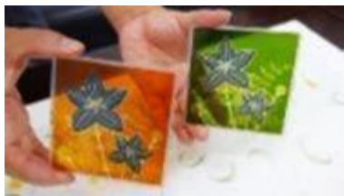
印刷で作る蓄電機能内蔵太陽電池（左）とこれを用いたスマホ充電器（右）
