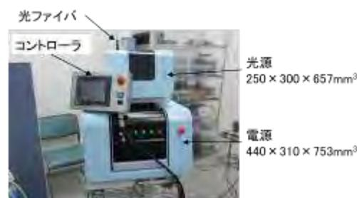
図 2-2-8 レーザシステム外観図
