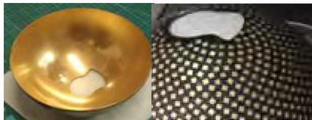
図 2-3-4 単結晶コンポジットを用いた半球形状の超音波センサ
