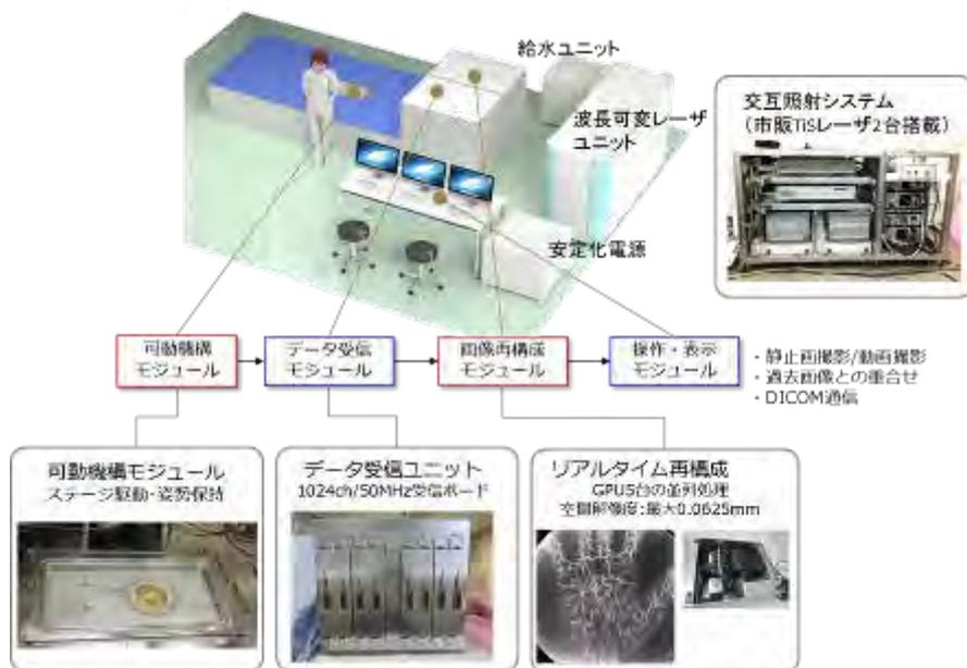
図 2-4-6 ワイドフィールド可視化システムの全体構成図
