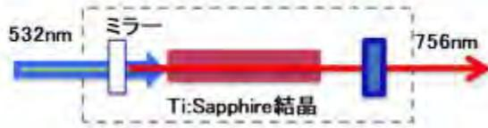
図 2-2-3 レーザ共振器構造
