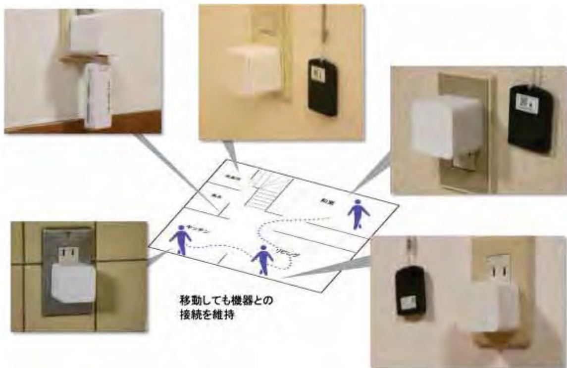
図 18 Wi-SUN 搭載ゲートウェイを利用した生体情報、環境同時モニタリングシステム
