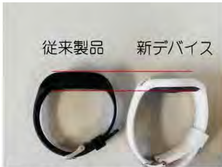
図5. 左の当社従来製品と右は、本プロジェクトで開発されたデバイス厚み 1 / 2 を実現した。
