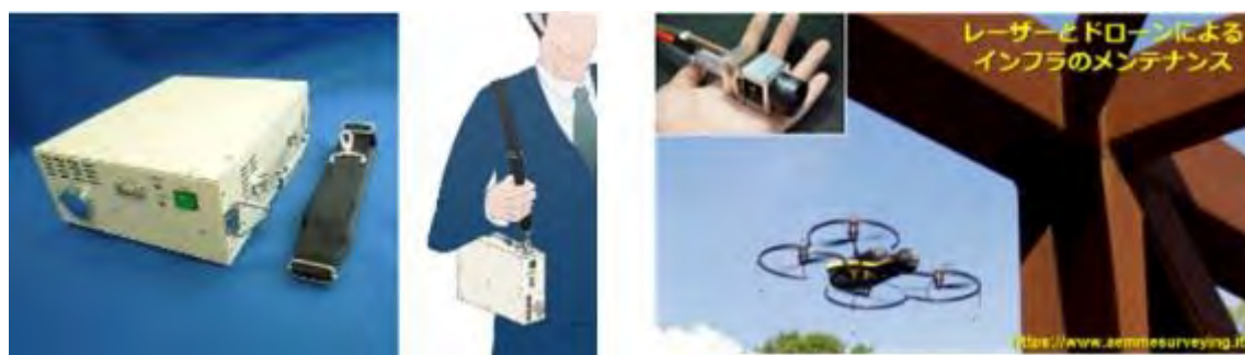
図 2-3-6 携帯型レーザー電源(左)とドローンによるインフラの点検・メンテナンス(右)
