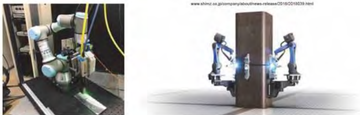
図 2-3-8 溶接中欠陥検査システム (左:レーザーおよびロボット部分、右:適用イメージ)
