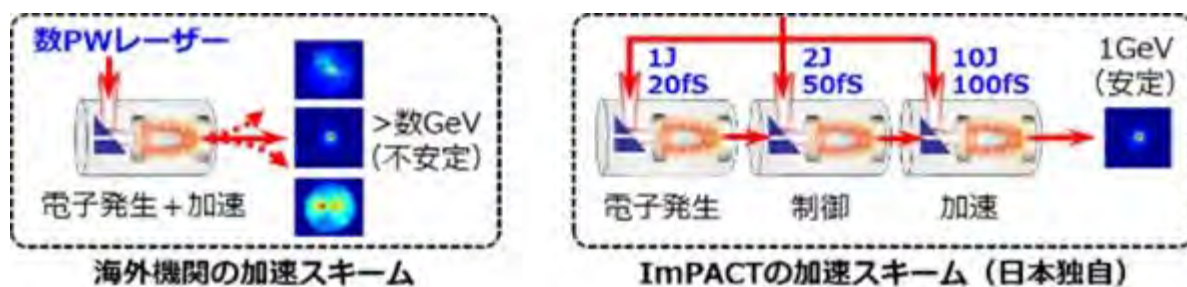
図 2-1-18 海外機関の電子加速スキームと ImPACT の電子加速スキーム
