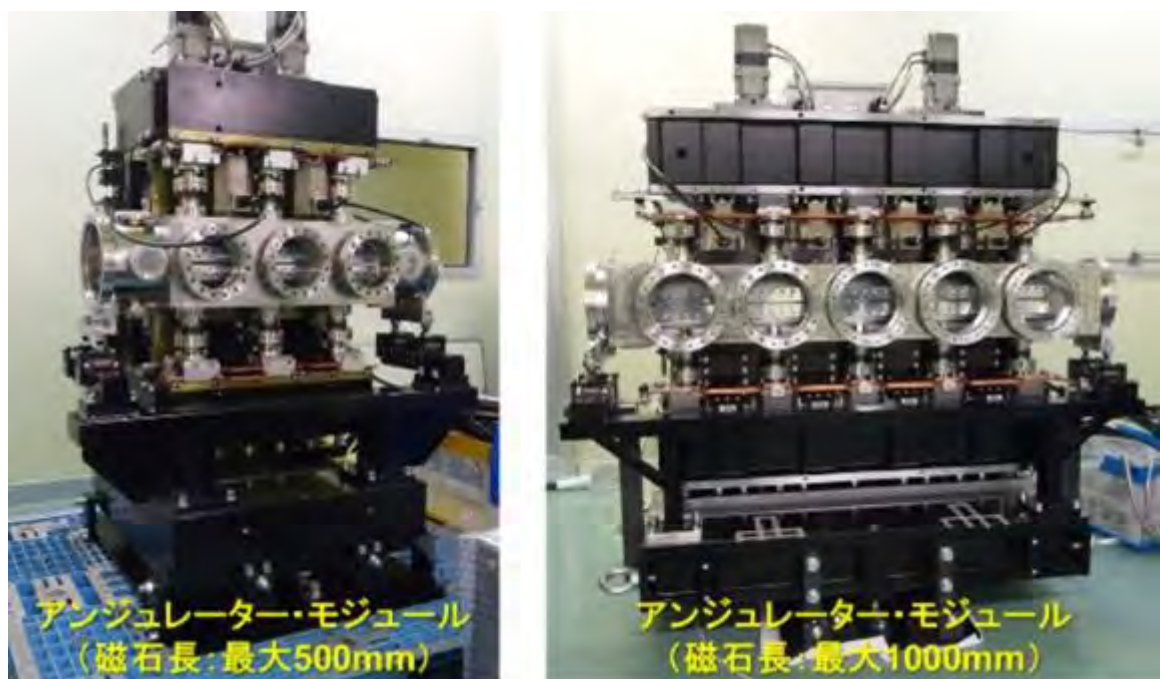
図 2-1-14 試作開発したアンジュレーター (左: 磁石長 0.5m、右: 磁石長 1m)
