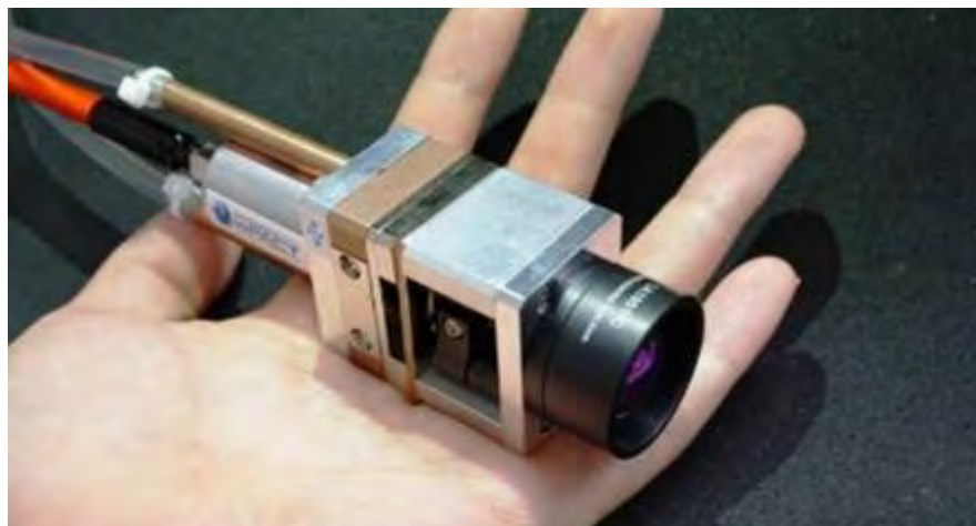
図 2-2-8 ハンドヘルドレーザー試作機 (パルスエネルギー20mJ)
