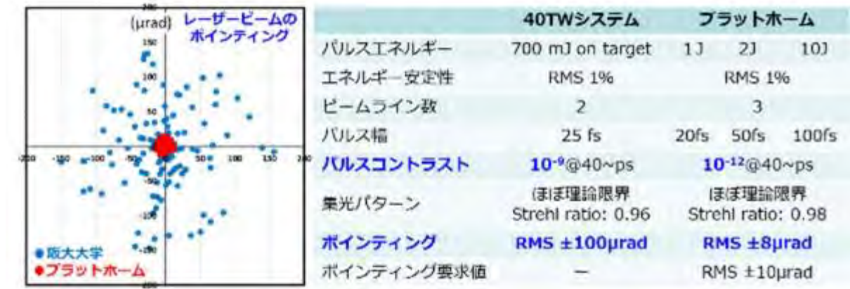
図 2-1-23 レーザーシステムの安定性 (阪大とプラットホームレーザーの比較)
