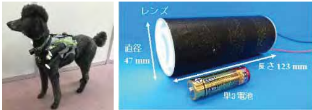
図2-1-31 LEDスポット光源を搭載した行動誘導スーツ（左）とLEDスポット光源（右）
