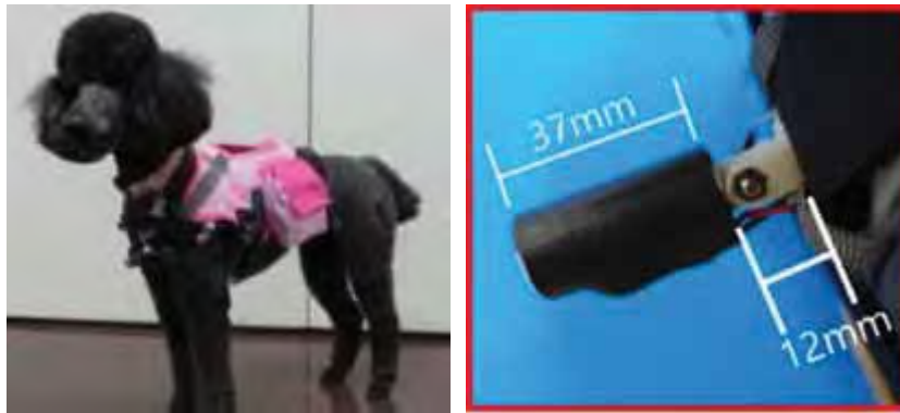
図2-1-30 小型レーザー光源を搭載した行動誘導スーツ（左）と小型レーザー光源（右）
