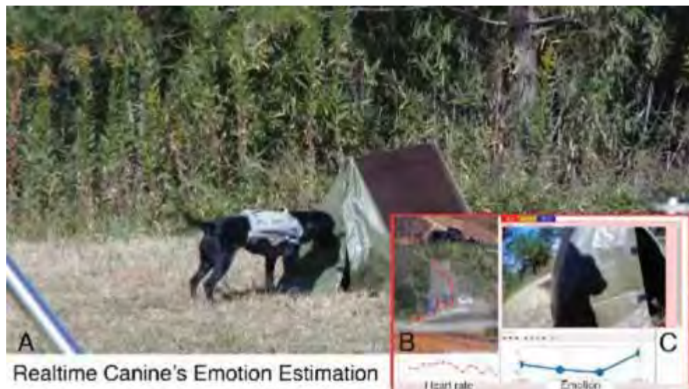
図2-1-16 災害救助犬の心電計測スーツの実用場面．Aに実際の災害救助犬の探査の様子が映っている．BとCが、ユーザーのGUIであり、Bに地理情報と心拍の変化が、Cに犬に搭載した小型カメラの映像と、推定された情動状態の結果がリアルタイムで表示されている．
