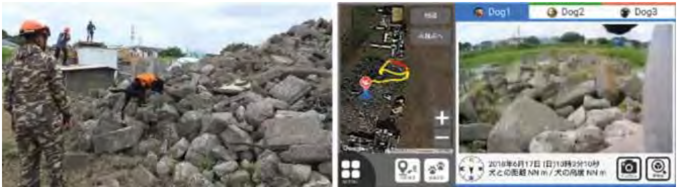
図2-1-6 日本救助犬協会の模擬瓦礫訓練で実用的なサイバー救助犬スーツとインターフェースを評価： （左）瓦礫を搜索する認定救助犬，（右）被災者を発見した位置と搜索した軌跡とカメラ映像
