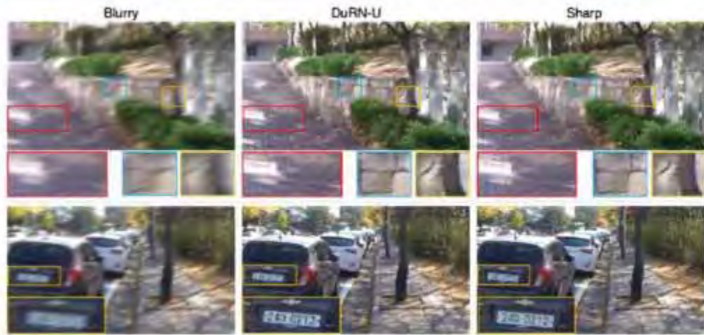
図2-1-24 開発したモーションブラー除去技術の適用例．左が入力画像．中央が処理結果．最後がブラーのない目標画像．
