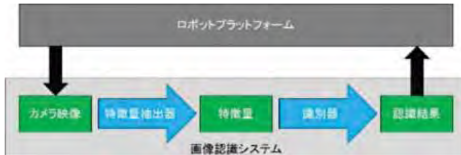
図2-1-9 画像認識システムとプラットフォームとのやり取りの大まかな構成
