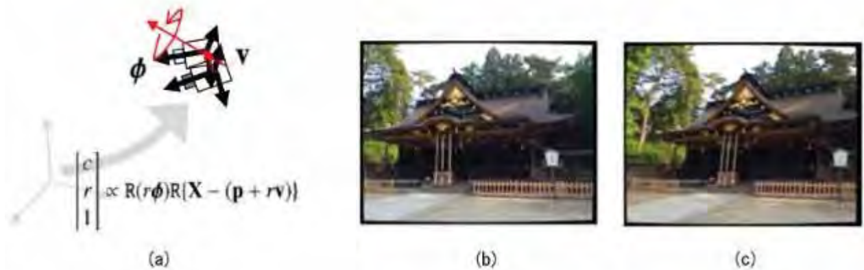
図2-1-22 開発したローリングシャッタ歪みモデルの概念図．
