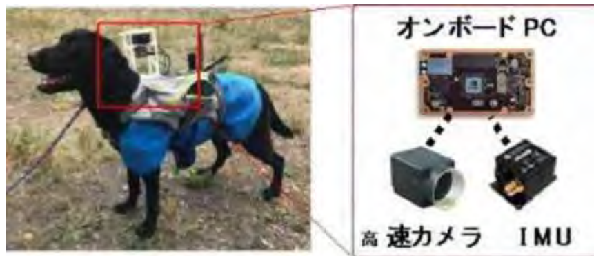
図2-1-21 イヌ用カメラスーツを装着した救助犬：カメラ，IMU，ボードPCを搭載
