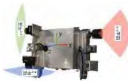
図2-4-41 各測域センサにおける計測平面
