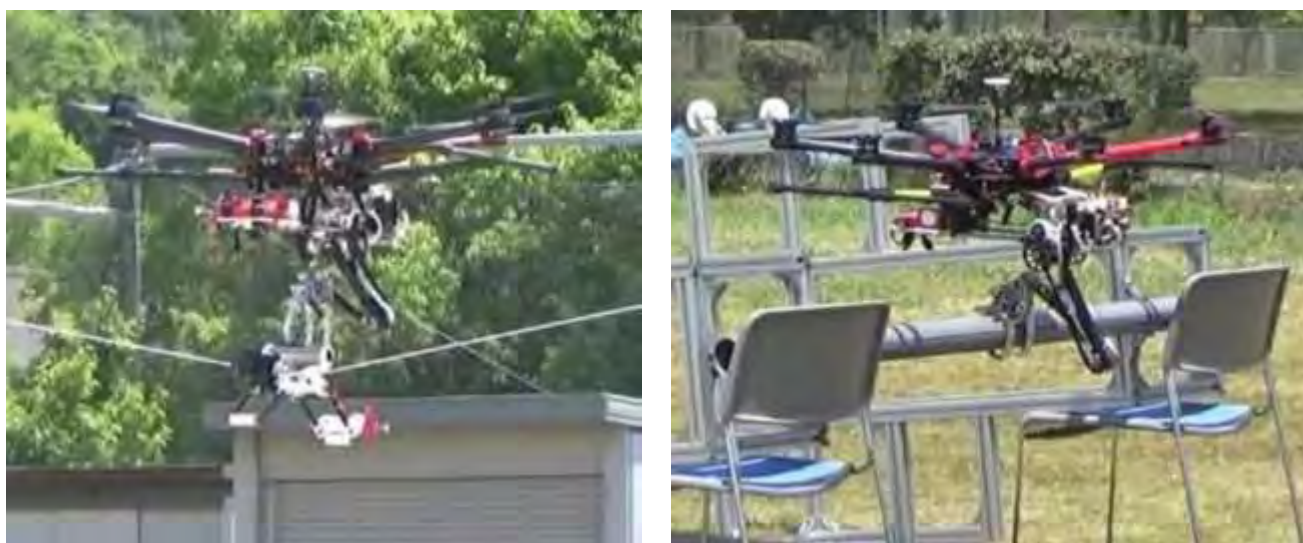
図2-5-7 カメラ設置とパイプ上への着陸
