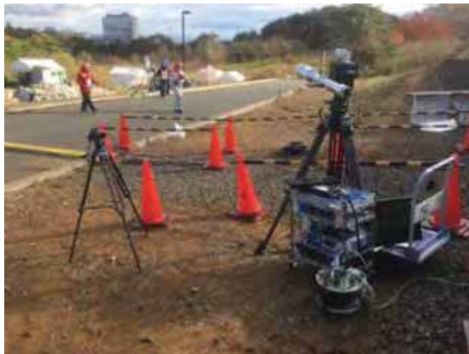
図2-5-43 組み立てたドップラーライダー本体と望遠鏡部
