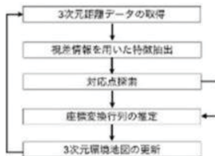
図2-4-27 測域センサアレイを用いた3次元環境地図構築のフローチャート
