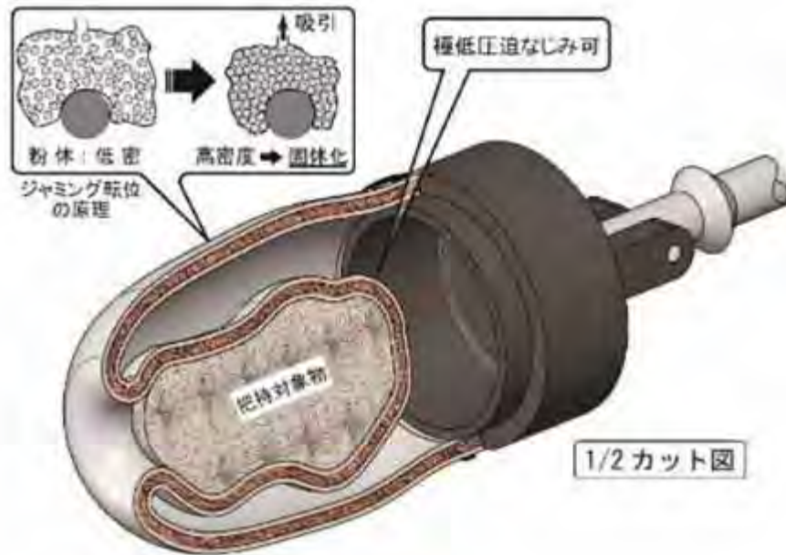
図2-5-59 柔軟ロボットハンドの構造
