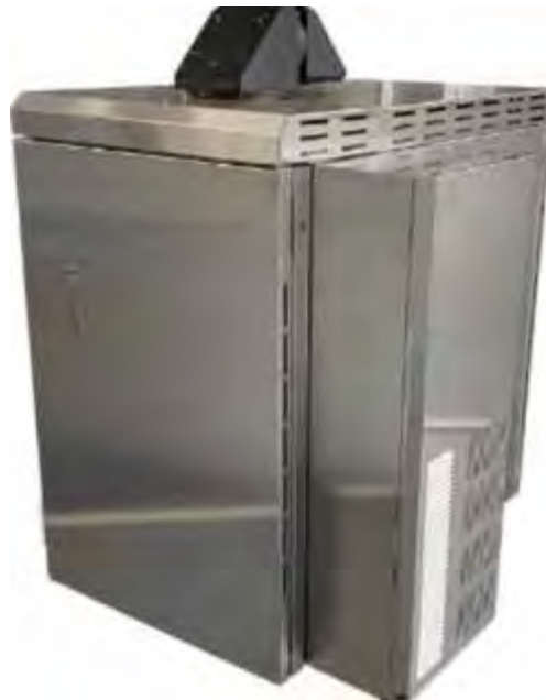
図2-5-45 市場向け可搬型ドップラー・ライダー
