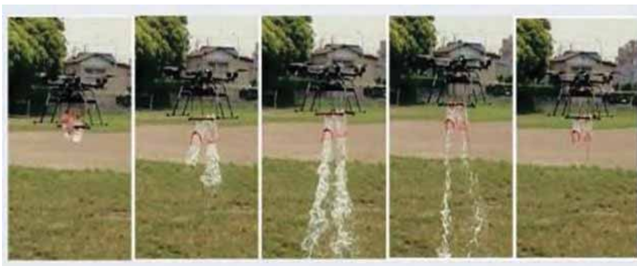
図2-5-2 飛行中に重量変化する機体の挙動
