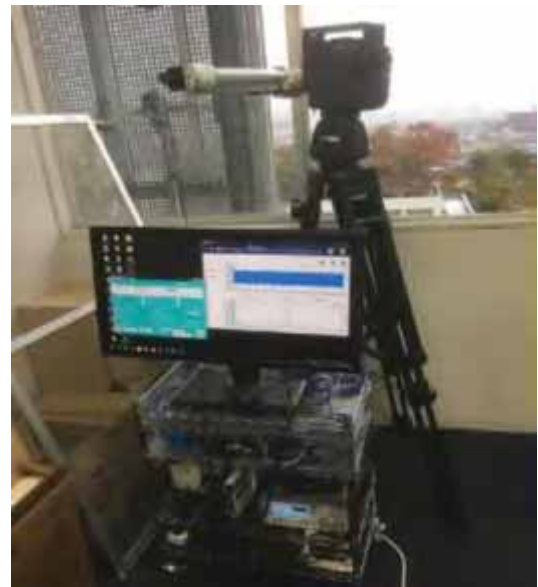
図2-5-43 組み立てたドップラーライダー本体と望遠鏡部
