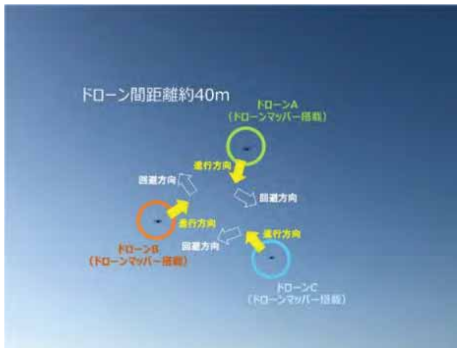
飛行制御試験時の様子（3機のドローンによるニアミス回避）
