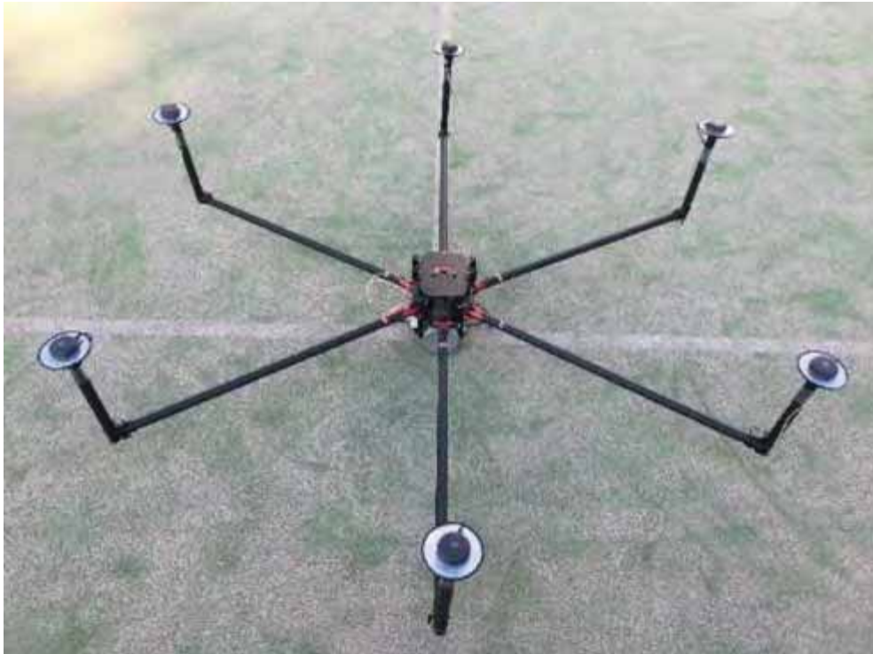
図2-5-31 複数GNSSアンテナ搭載の三次元計測システム
