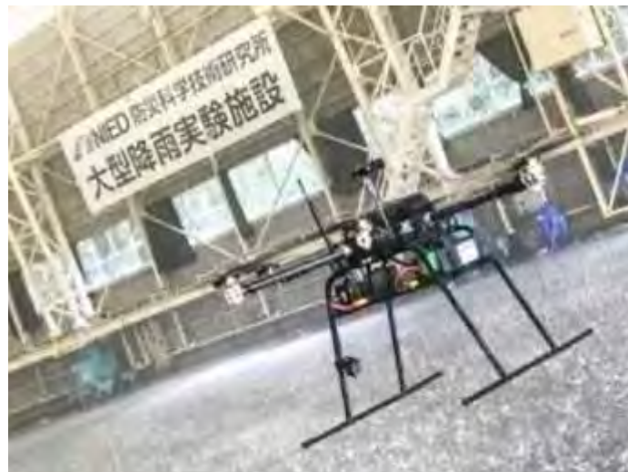
図2-5-5 300mm/hの環境下での飛行試験の様子
