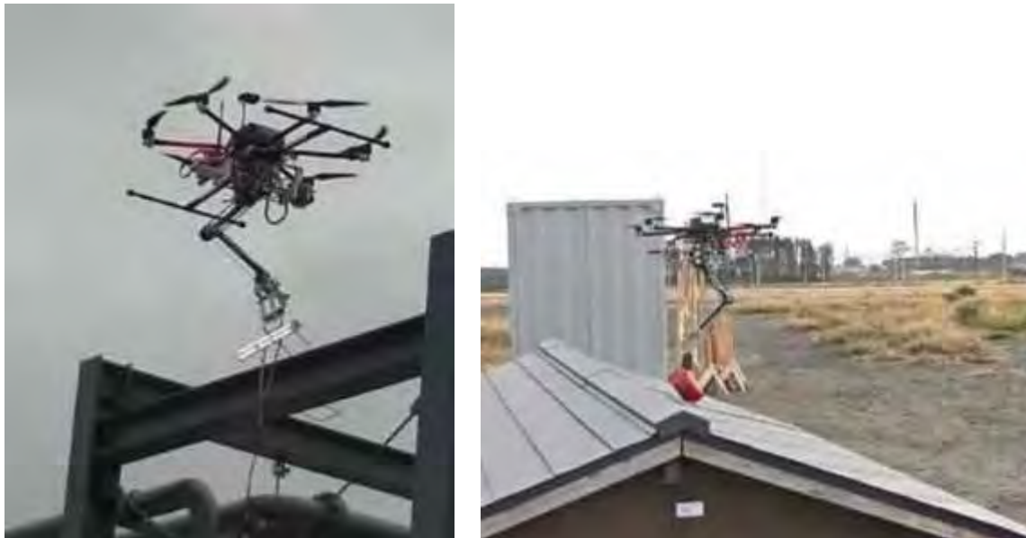
図2-5-8 物資運搬 左：高所へのLED灯を運搬，設置 右：傾斜地への救急医療品運搬，設置
