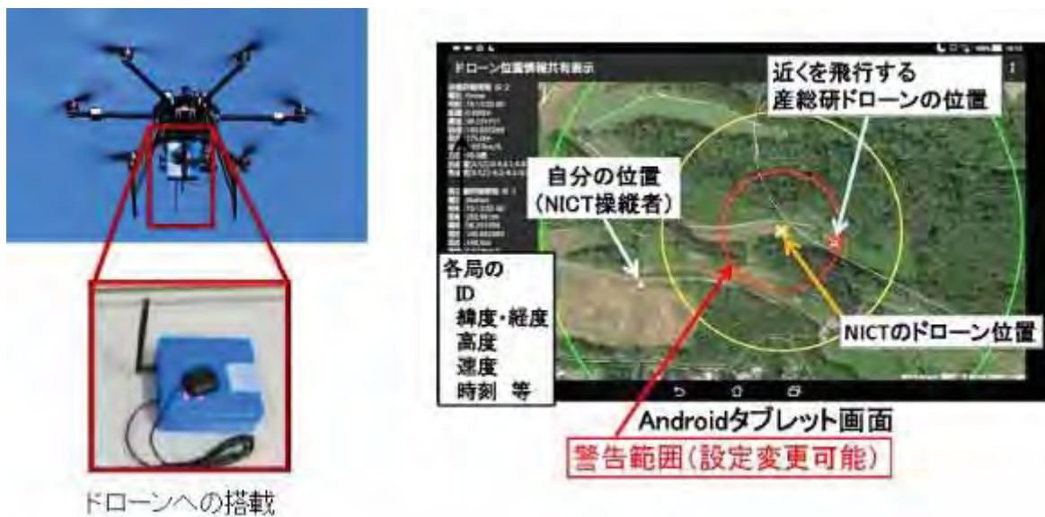
図 2-5-30 ドローン等飛しょう体間の位置情報共有システム（ドローンマッパー）
