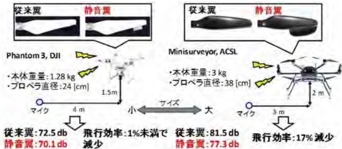
図2-5-9 Phantom用プロペラ，ミニサーベイヤ用プロペラでの低騒音型翼。
