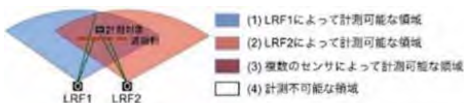
図2-4-28 測域センサアレイにおける遮蔽領域の定義
