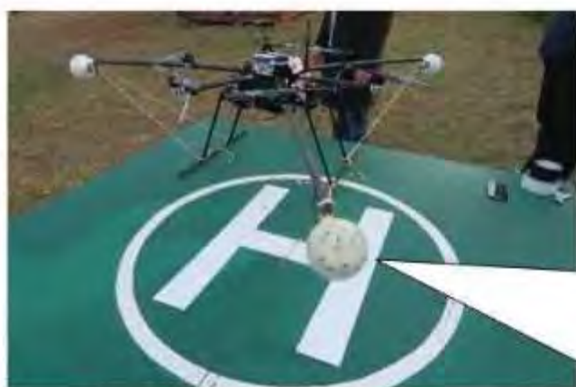
マイクロホンアレイ搭載ドローン (後方の2つはカウンターウェイト)
