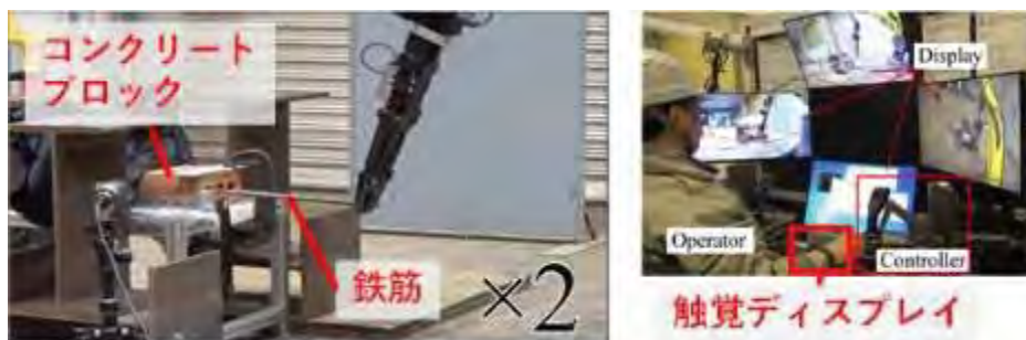
図2-6-32 鉄筋のブロックへの挿入タスク
