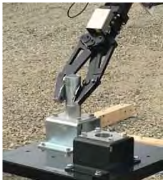
図2-6-9 ピンの嵌合作業(隙間50ミクロン)
