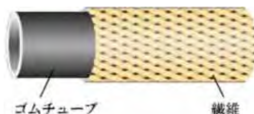
図2-7-19 マッキベン型人工筋肉の構造
