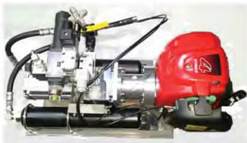
図2-7-16 エンジン式パワーパックの一例
