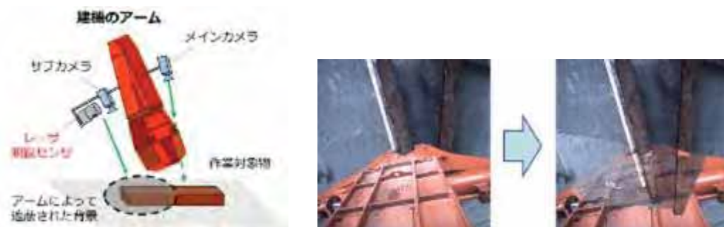
図2-6-17 半隠消映像システム（左：半隠消映像システムの全体像、右：半隠消映像）
