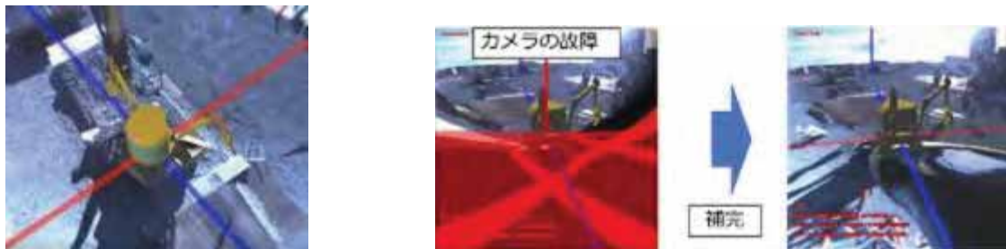
図 2-6-16 俯瞰画像（左：ロボットの向き、右：カメラ故障時の補完）
