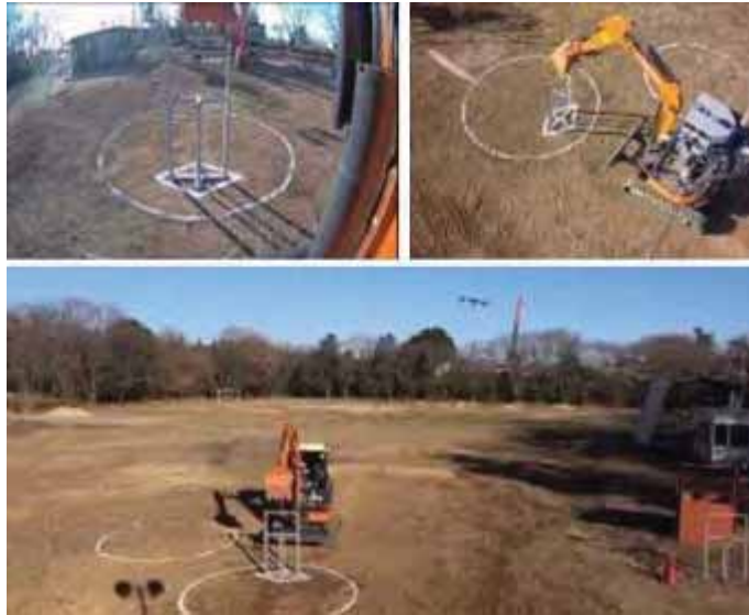
図2-6-14 有線給電ドローンを用いた遠隔操縦試験
