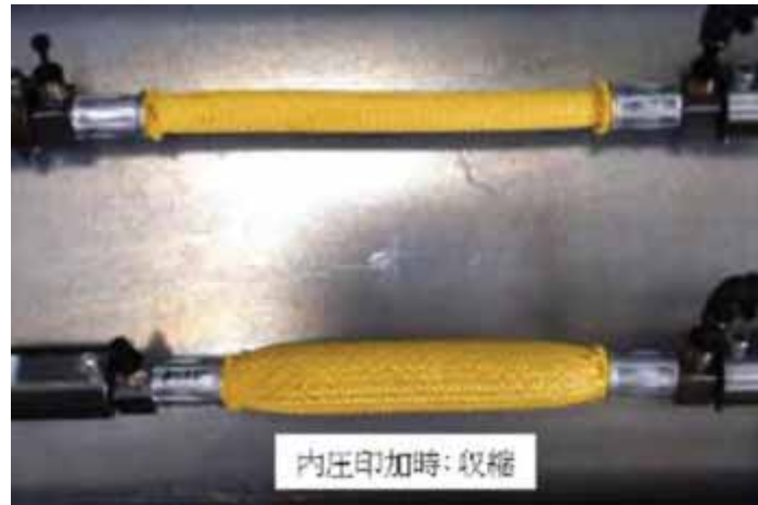
図2-7-20 作製した人工筋肉のプロトタイプ（直径15mm 長さ280mm）
