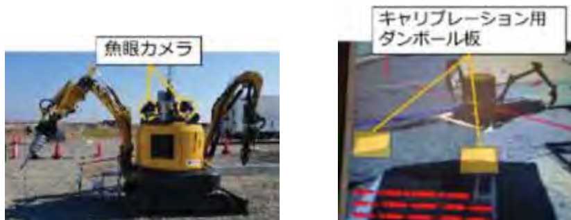
図 2-6-15 俯瞰画像（左：ロボットに搭載したカメラの配置位置，右：キャリブレーション）
