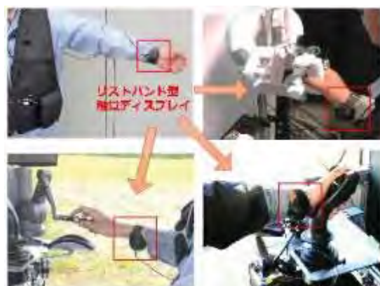
図2-6-29 様々な形態のインタフェースに適用可能なリストバンド型触覚ディスプレイ
