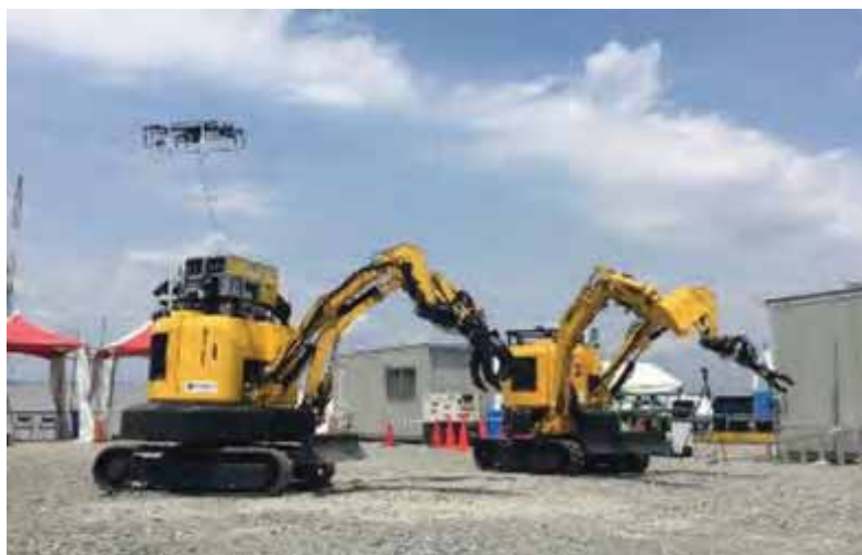
図2-6-6 建設ロボットプラットフォーム 1号機，2号機
