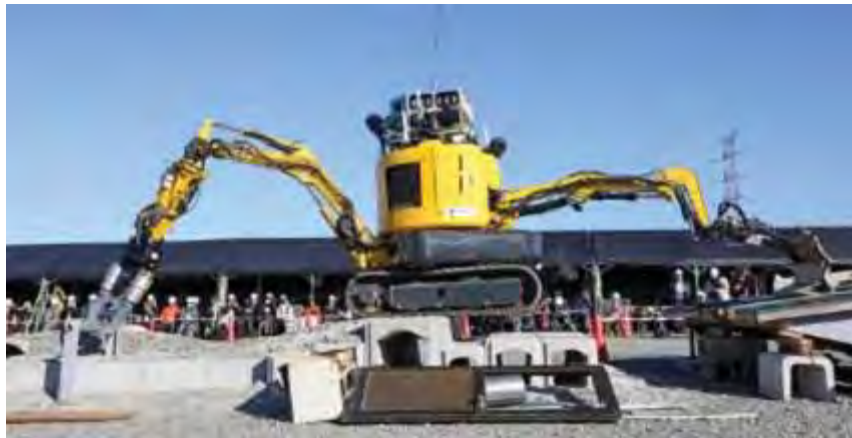
図 2-6-1 建設ロボット (不安定な足場上で片腕で自分を支えて倒壊家屋を探索 2018.11@福島 RTF)
