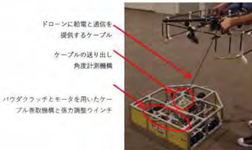
図2-6-11 開発した有線給電ドローンならびにヘリパッド
