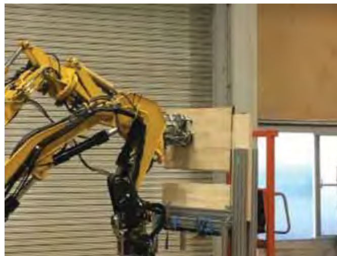
図2-6-8 部材の組立実験
