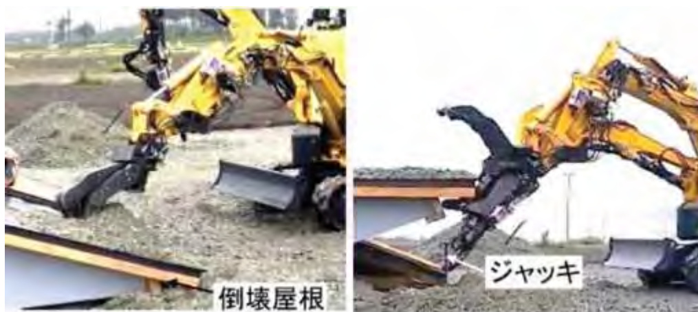
図 2-7-49 テストフィールドでのタスク実行の様子 (福島RTF (Robot test field) におけるImPACTフィールド評価試験)
