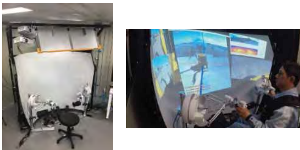
図 2-6-38 遠隔操作コクピットの外観と操作の様子
