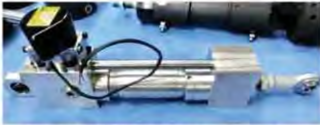
図 2-7-3 多軸鍛造マグネシウム合金による 小型軽量・高出力低摺動シリンダ （サーボ昇搭載，最大推力 11 kN）
