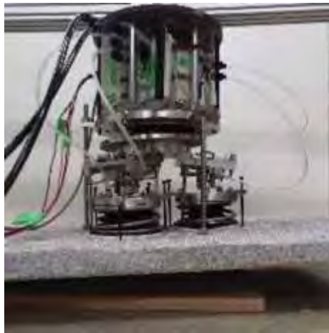
図 2-6-43 吸着コンポーネントによる石材パネルの持ち上げ
