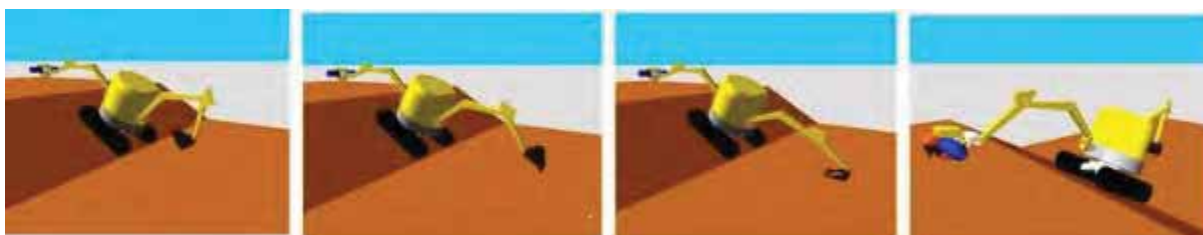
急斜面での掘削作業（斜面上方の物体把持による車体の安定性確保）
