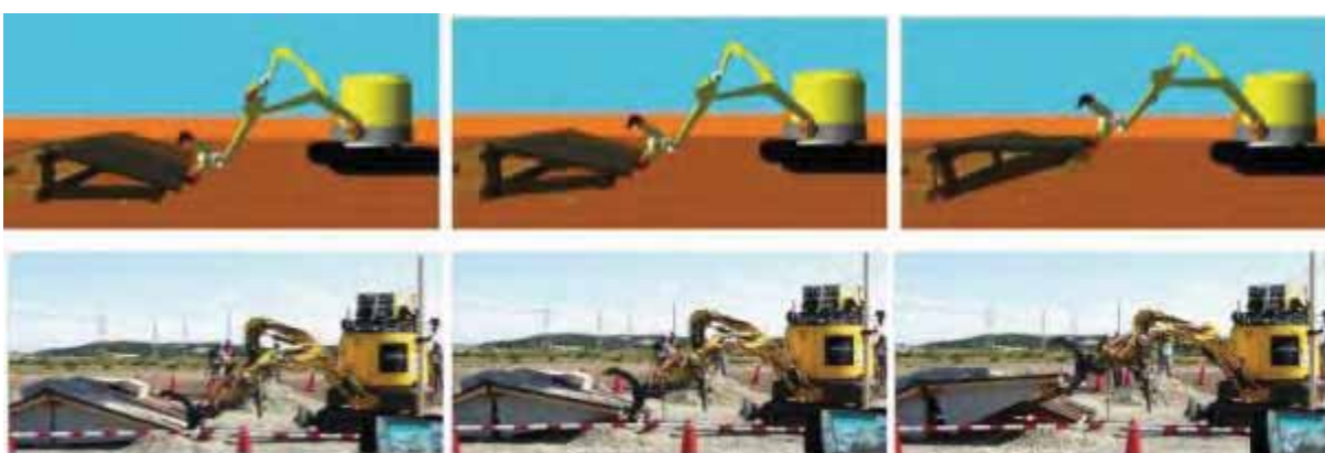
建設ロボットの屋根持ち上げ検証シミュレーション （上段：動力学シミュレーションによる検証，下段：実際のフィールド実証における作業）
