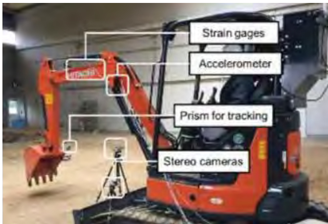
実機バックホウによる掘削実験
