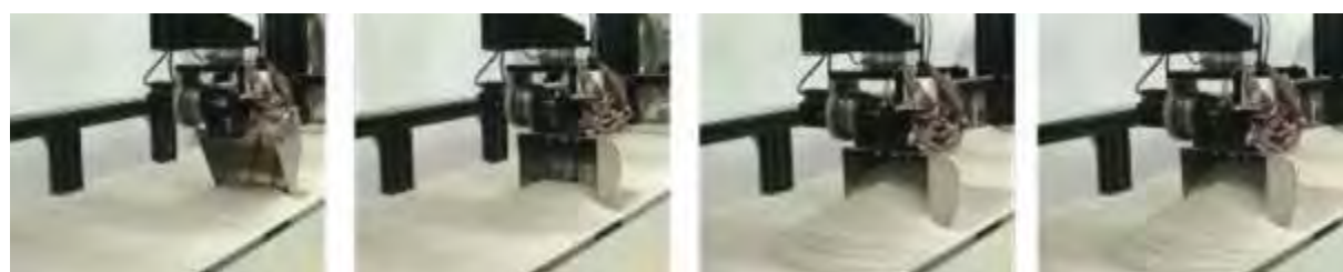
図2-8-15 3自由度土壌掘削実験装置
