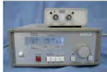
図 29 細菌・ウイルス・バイオエアロゾル計測のプロトタイプ
