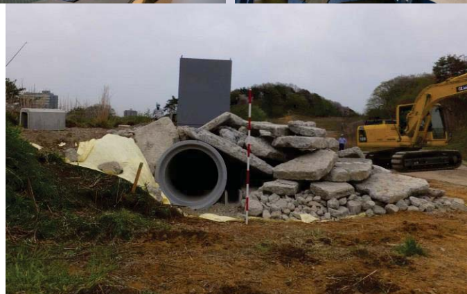
屋外瓦礫フィールド 熊本大地震・阪神淡路大震災の調査結果に基づき、倒壊家屋内部、コンクリート瓦礫を再現
