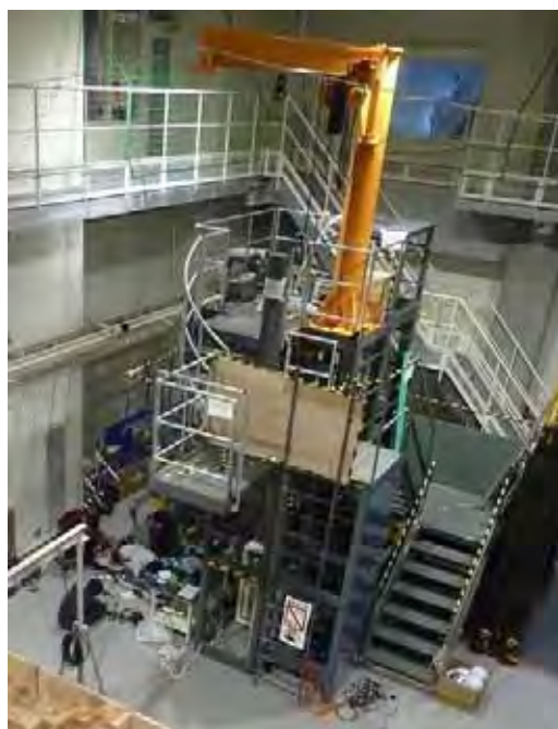
屋内フィールド プラント現場を模擬した、 ロボット評価試験フィールド
