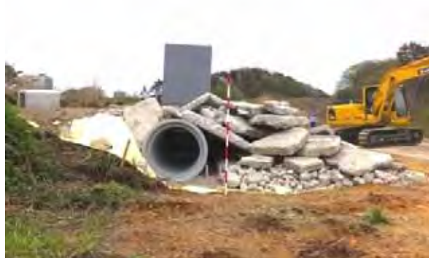
屋外瓦礫フィールド 熊本大地震・阪神淡路大震災の調 査結果に基づき、倒壊家屋内部、 コンクリート瓦礫を再現
