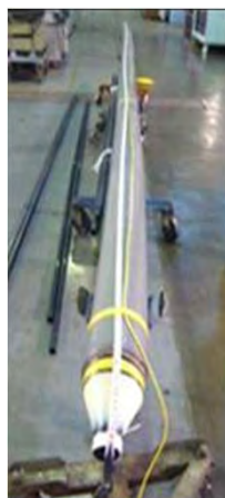
1.2MV対応 試作ケーブル
