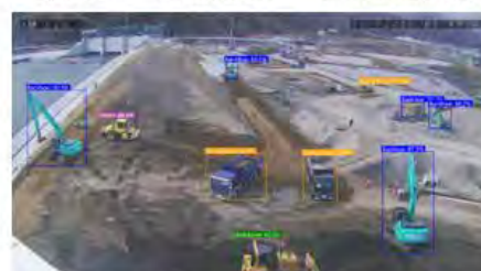
建機検出AIによる識別結果
