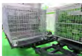
無人の運搬台車がキャベツの入ったコンテナを自動で交換し、ほ場外へ搬出
