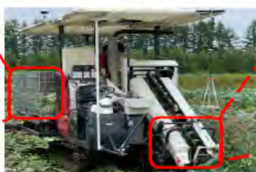
無人の運搬台車がキャベツの入ったコンテナを自動で交換し、ほ場外へ搬出
