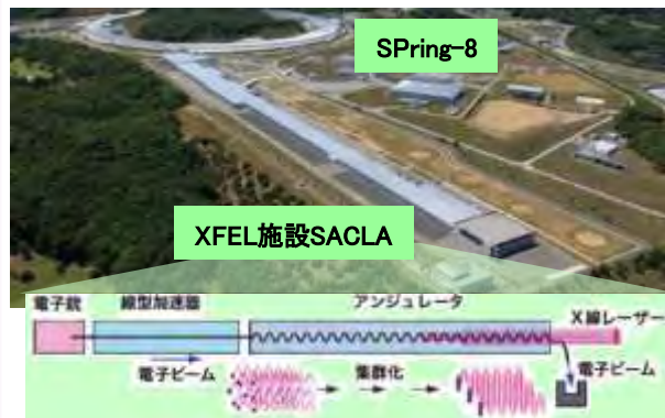
（アンジュレータ：その間隔を通り抜ける電子を周期的に加速させて特定の波長を持つ光を作り出す装置）
