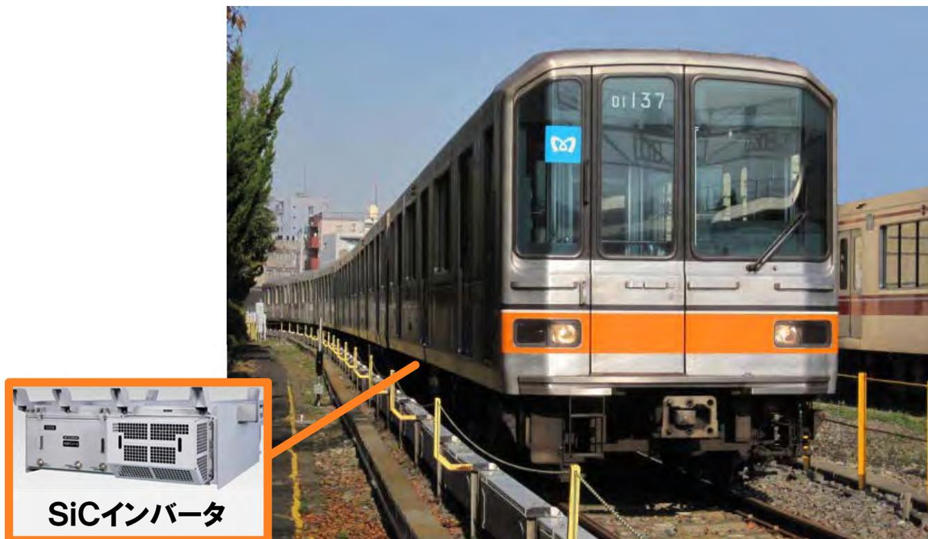
SiCインバータ等を搭載する銀座線01系37編成
